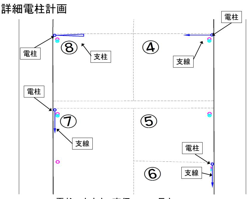
電柱 大きさ 直径40cm 長さ13.5m
