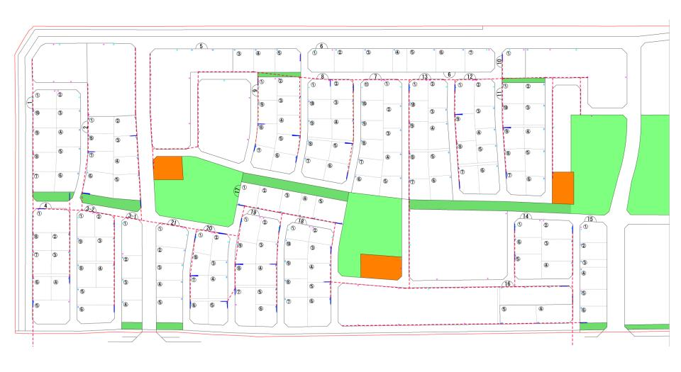
○ 共架柱 → 支線 △ 支柱 <sup>……</sup> ケーブル
